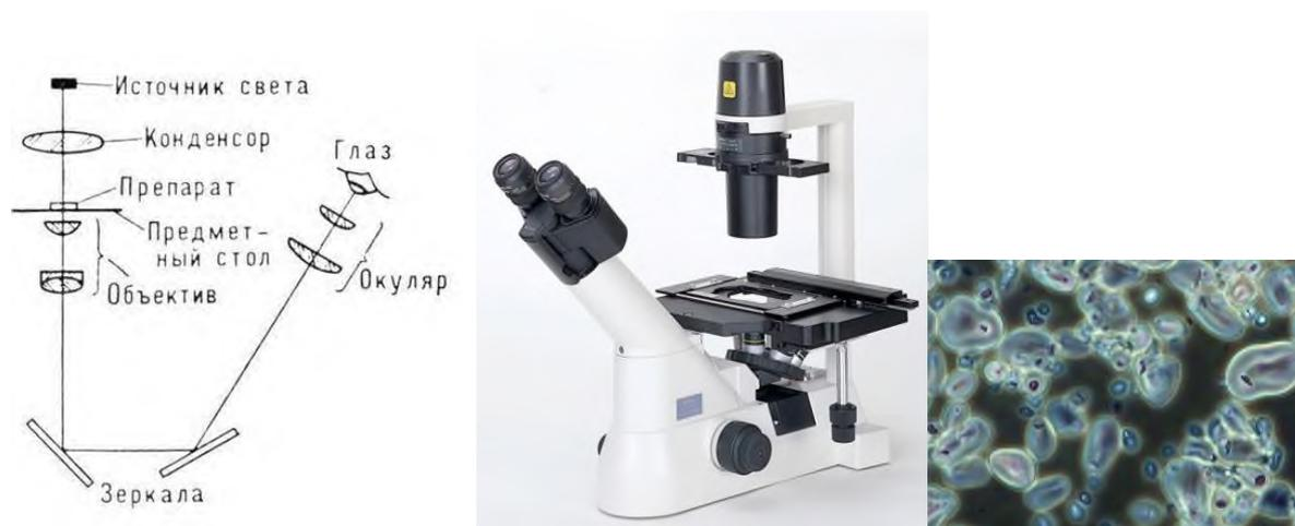
**Рис. 26.** Схема получения изображения объекта в инвертированном микроскопе [biojojo.blogspot.ru], современный инвертированный микроскоп и пример изображения в нем [melytec.ru].
